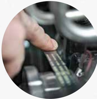
Zeer eenvoudige controle van de V-snaar.
